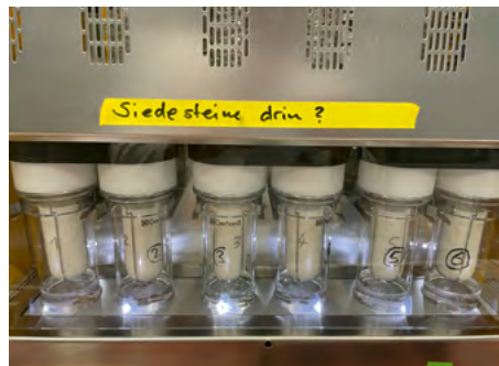
Abb. 1: Aufbau der Extraktion: Glasbehälter mit Extraktionshülsen gefüllt mit Biomasse im Soxhtherm der Firma Gerhard.
